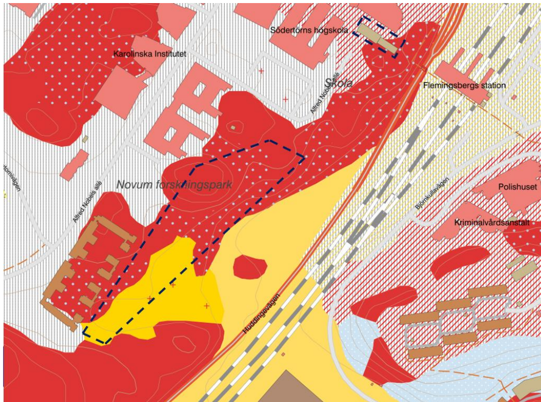
Figur 5, SGU jordartskarta (gult=lera, rött=berg, blåprickigt=tunt moräntäcke, gråskrafferat=fyllning).
